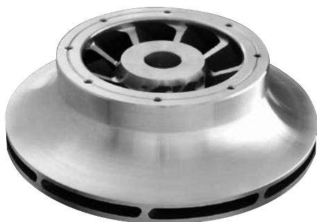
Abb. 12 Verdichterlaufrad Lange Laufzeiten mit höchsten dynamischen Belastungen erfordern hier besonders niedrige Fe-Gehalte der Anticorodal-70 dv, T64 mit besonders langer Lösungsglühzeit. Ø 215 x 60 mm; 2,1 kg
