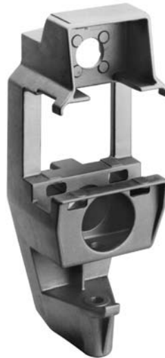
Abb. 11 Elektrohängebahngehäuse Hohe Sicherheitsanforderungen im Überkopf-Förderbereich erfordern hohe Verformbarkeit der Gussstücke aus Anticorodal-70, T64, bevor ein Bruch zum Abriss führt. 760 x 280 x 250 mm; 18,5 kg
