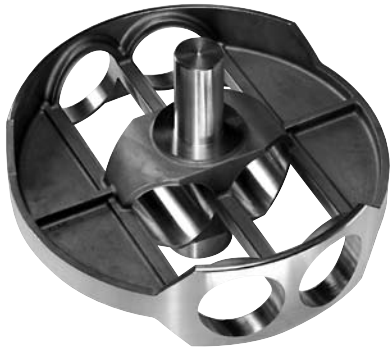
Abb. 8 Verteilerteller für Getreidemehl Die Anwendung der Anticorodal-70, T6 im Gussstück in Lebensmittel verarbeitenden Maschinen entspricht der EN 601. Ø 600 x 240 mm; 6,3 kg
