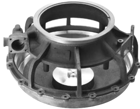
Abb. 9 Druckausgleichsgehäuse, Airbus Anticorodal-72, T6 hält die besonderen Temperaturbelastungen bis hin zu minus 90 °C im Flugzeugaußenbereich ohne Versprödung aus. Ø 295 x 190 mm; 2,1 kg
