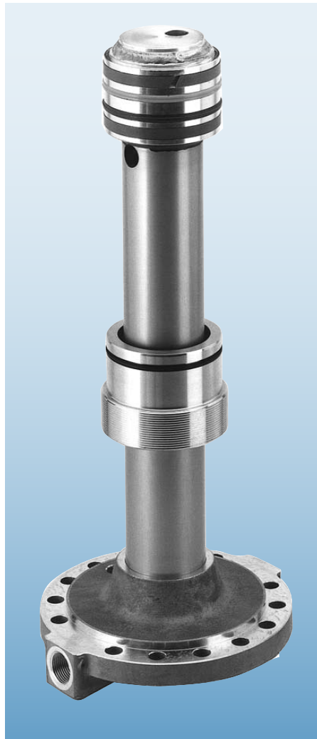
Abb. 1 Stoßdämpfer für Einzelradaufhängungen in Schwerlastfahrzeugen. Schweiß- und Schraubkonstruktion aus drei Kokillengussstücken aus Anticorodal-70 dv, T6; Ø 235 x 560 mm; 9,2 kg.
