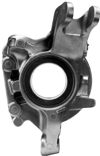
Abb. 10 Radsatzlager Die hohe Korrosionsbelastbarkeit der Anticorodal-70, T6 wird neben der dynamischen Belastbarkeit im steinschlaggefährdeten Bereich der Radaufhängung besonders gefordert. 320 x 200 x 160 mm; 3,5 kg
